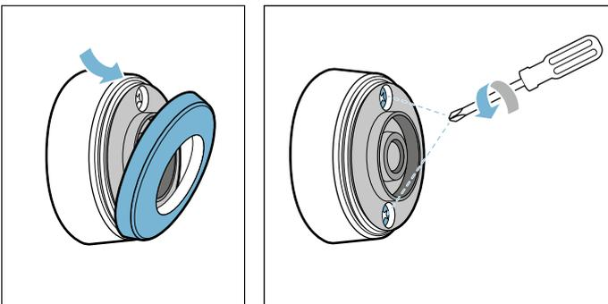
2. Das Gehäuseoberteil abziehen. Die alte Batterie entfernen. Die neue Batterie einschieben. Dabei auf die Polung achten.
